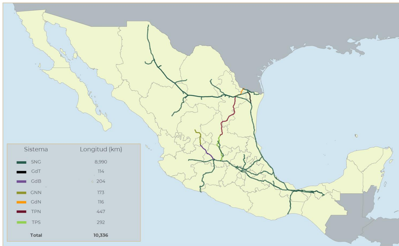
FIGURA 1. SISTEMA DE TRANSPORTE Y ALMACENAMIENTO NACIONAL INTEGRADO DE GAS NATURAL.
