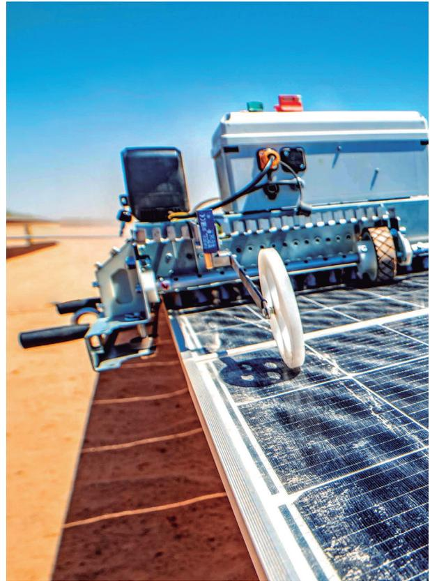
**Fotografía 26.** Robot limpiando equipo fotovoltaico. Puerto Peñasco, Sonora. Comisión Federal de Electricidad.
